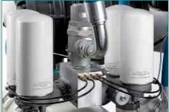
Les compresseurs jusqu'à 160 kW, sont équipés de séparateurs extérieurs qui peuvent être remplacés dans le simple processus d'ouverture et de fermeture par rotation. Les installations de plus grande taille possèdent une cartouche séparatrice intérieure. Grâce au degré de séparation performant de l'ensemble du système, les compresseurs disposent d'une plage de pression de 5,0 à 15,0 bar. Pressions spéciales sur demande.
